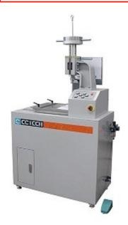
Cet équipement d'essai est utilisé pour déterminer le coefficient de frottement statique à sec des matières de la semelle et du talon d'une chaussure. Sous une charge spécifique sur une surface de marche contrôlée, il calcule ses forces tangentes et perpendiculaires pour obtenir le coefficient de frottement statique.
